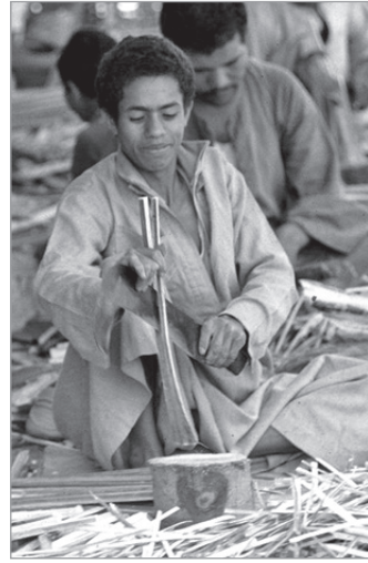
الشكل (أ/٢) حرفي يمارس صناعة أقفاص الجريد.
